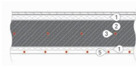
Im Neubau integriert man die Rohre für die Aktivierung des Deckenspeichers direkt in den Betonkern der Massivdecken. Je nach Deckensystem geschieht das bei der Vorfertigung im Werk oder bei der Betonage vor Ort. Eine Dämmschicht unter der Betondecke bildet den Abschluss des Deckenspeichers. Unter diese Konstruktion kann nun eine Klimadecke installiert werden – direkt montiert oder abgehängt.
