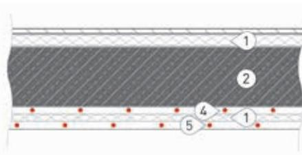
Eine vorhandene Betondecke lässt sich auch nachträglich als Deckenspeicher aktivieren: Hierfür montiert man zunächst die Wärmeleitprofile und Rohre unter die Betondecke. Darunter kommt nun eine Dämmebene, die mit Tragprofilen kombiniert ist. In diese Tragprofile werden die Wärmeleitprofile für die Klimadecke eingehängt und abschließend alles mit gängigen Trockenbau-Platten beplankt.
